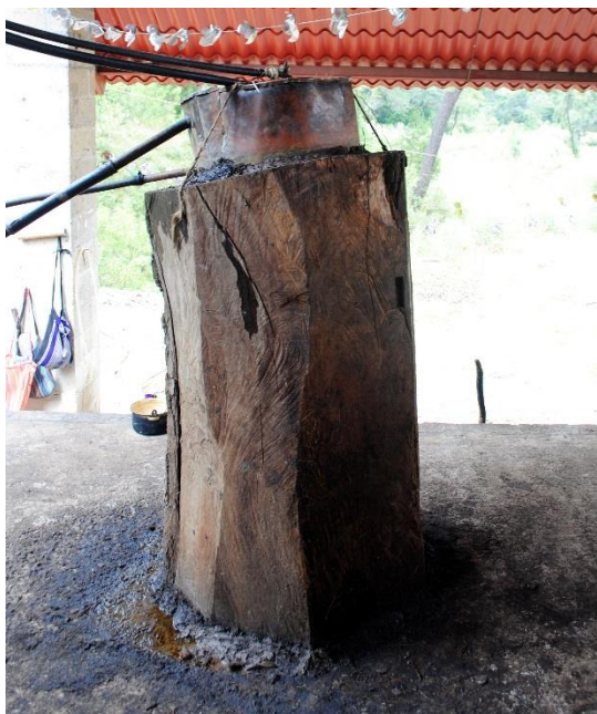
Imagen 7. Cascomite y montera de cobre Foto: Kay H. Diego
