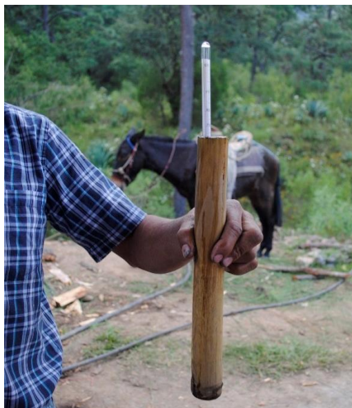
Imagen 8. Medición de la graduación alcohólica del mezcal Foto: Kay H. Diego
